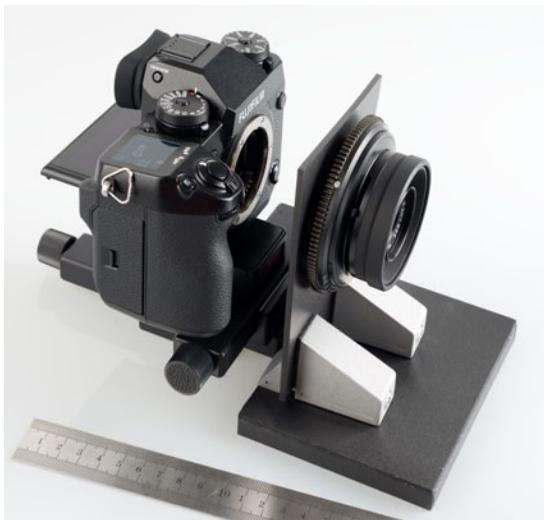
Mit einer provisorischen Halterung für das Objektiv und einem Einstellschlitten kann der für einen Balgen zur Verfügung stehende Platz mithilfe der Kamera ermittelt werden. Gemessen wird der Abstand zwischen Objektivauflage und Kamerabajonett, wenn ein auf unendlich gestelltes Motiv scharf auf dem Display erscheint.
