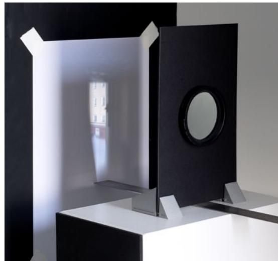
Bei Einzellinsen lässt sich der Abstand zwischen Objektivebene und Bildebene ermitteln, indem man Linse und eine improvisierte Fassung in eine passende Halterung stellt und verschiebt, bis sich ein scharfes Bild eines weit entfernten Objekts auf einem weißen Hintergrund zeigt. Den Abstand kann man nun messen und als Basis für den Kamerabau verwenden.
