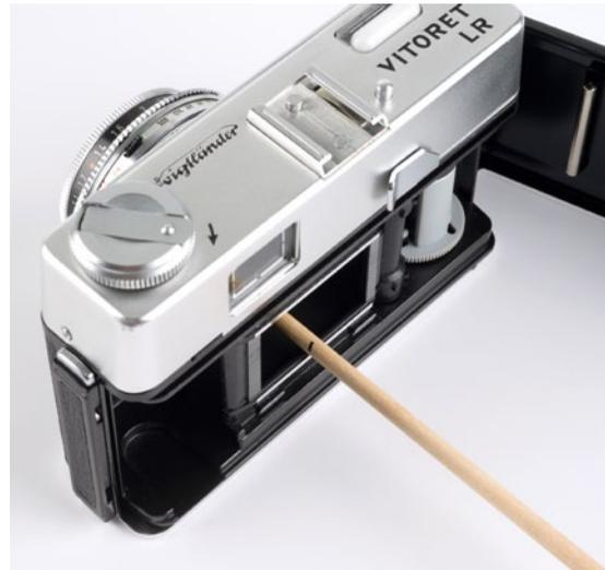
Hat man keinen Messschieber zur Hand, lässt sich auch ein Holzstab verwenden, bei dem man das Messergebnis mit einem Stift markiert und es später mit einem Lineal abmessen kann.
